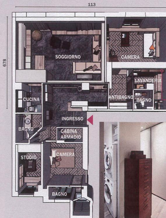
**Anche le pareti di disimpegno e ripostiglio** sono state demolite per ampliare la camera singola, creare un piccolo bagno e una zona lavanderia. Questa è definita da una struttura che fa da appoggio agli arredi.
